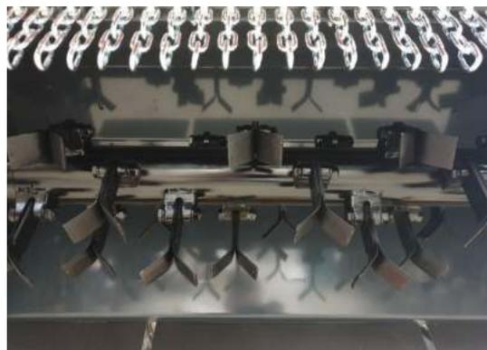
Sistema de cuchillas posicionadas en pares en forma de Y.
