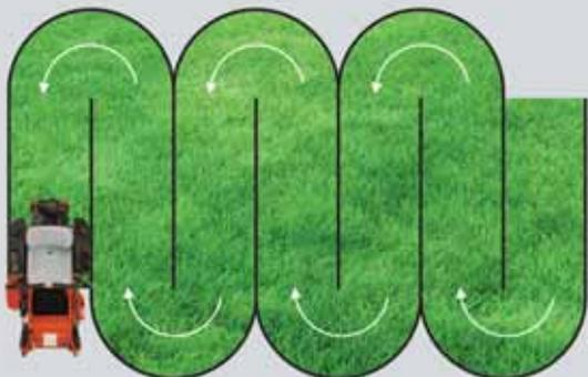
Un cortacésped de giro cero le permitirá cortar el césped de manera eficiente, ya que puede girar 180° al final de una fila de corte. No hay necesidad de conducir sobre áreas previamente cortadas o perder tiempo retrocediendo para maniobrar para realizar la próxima pasada.
